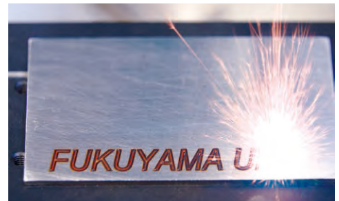
レーザーを使った微細加工 レーザーを使って金属片に文字を刻印しています
