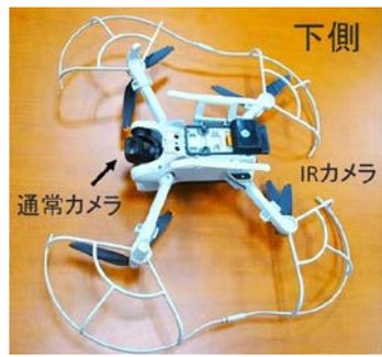
図1：カメラユニット実装ドローン 図2：同背面
