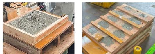
写真-1 外殻 PCa 板製作状況
