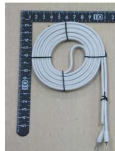
図 2 プローブコンデンサ
