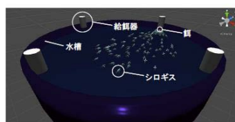
図5 給餌シミュレータ
