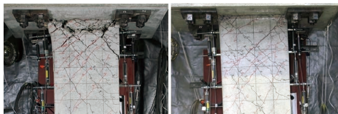
構造実験 破壊状況の比較 (左:工夫なし, 右:工夫あり)
