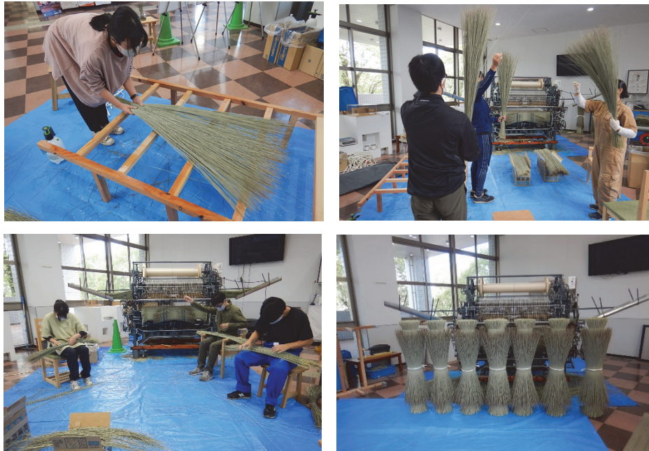
図 6-14 藁草選り出しと三蔵中継織機による製織（福山大学）
