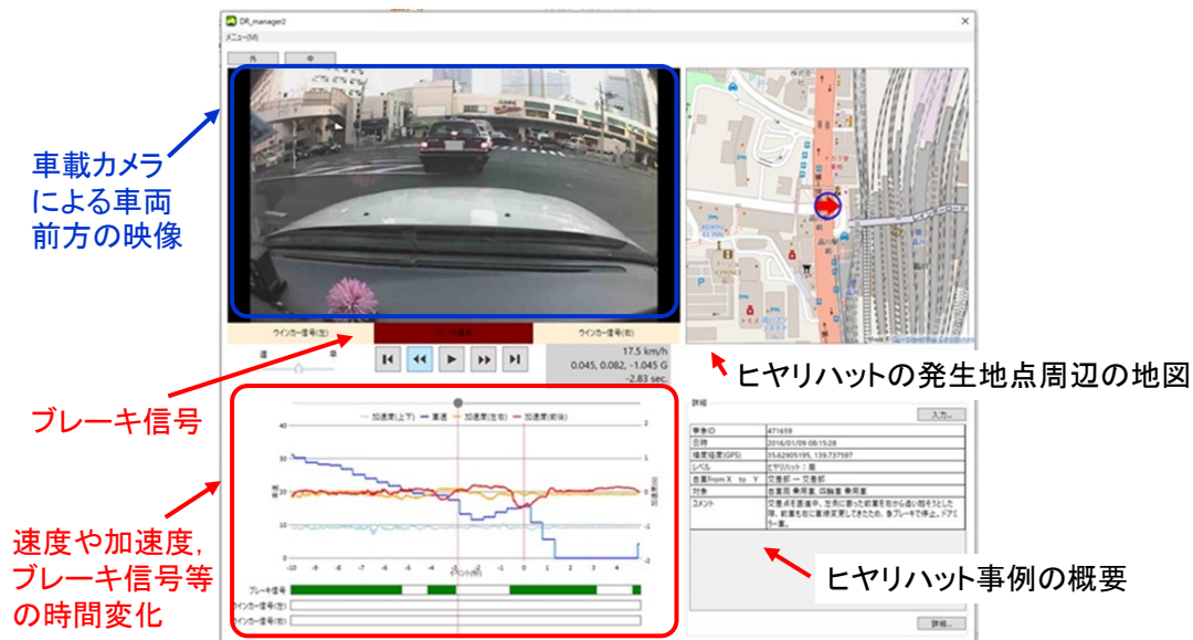
図1 ヒヤリハットデータベースに保管されているヒヤリハット事例の内容構成
