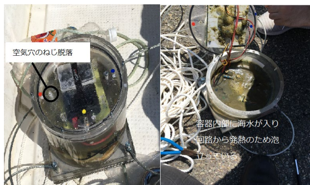
図 5.7 浸水した海底カメラ
