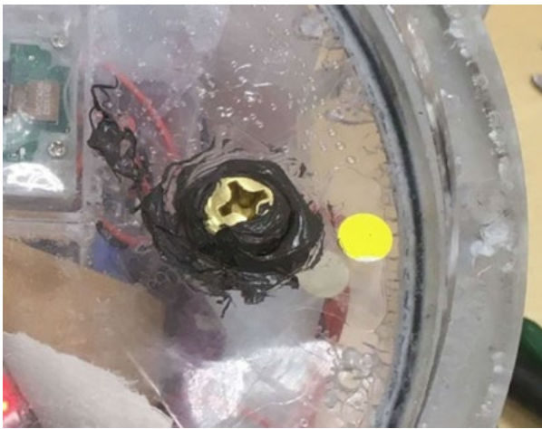
図 2.7 ねじの内部に K 電対が埋め込まれている Fig. 2.7 A thermocouple is embedded under the screw.
