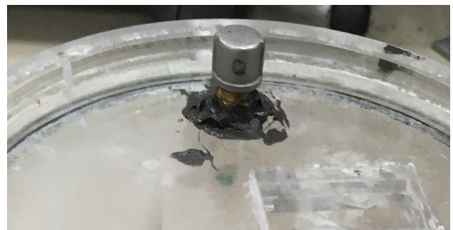
図 2.6 一方弁 (チェックバルブ) と金属キャップ Fig. 2.6 The check valve and its metal cap.
