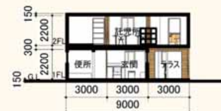
施設②+少人数世帯住宅 A-A断面図 S=1/100
