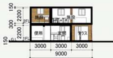
施設+少人数世帯住宅 A-A断面図 S=1/100
