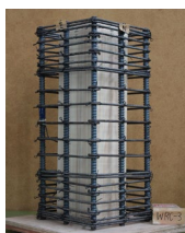
写真 1 WRC2 試験体配筋状況
