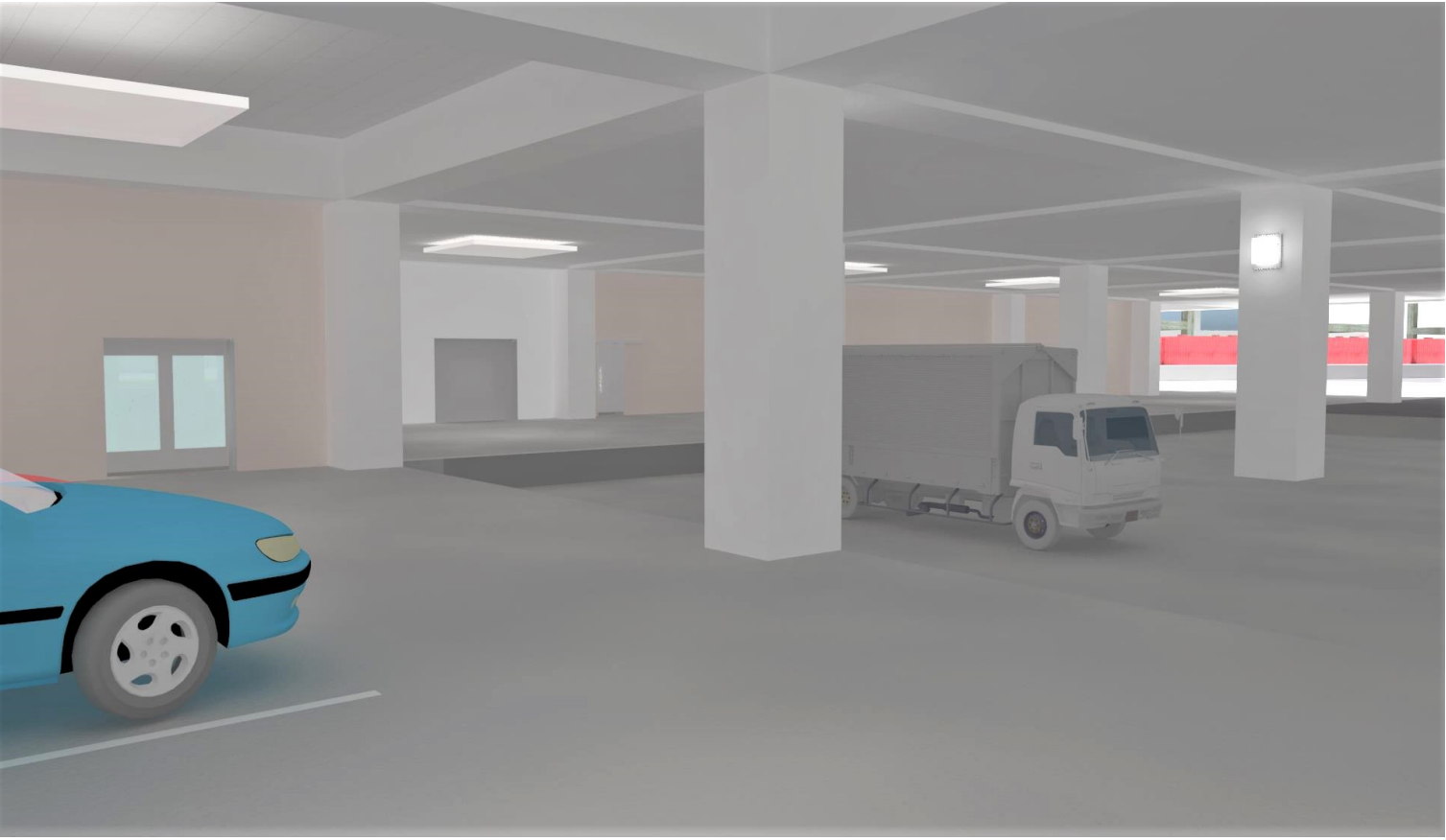
搬出入口及び、事務所等の外観図 トラックからの積み降ろしが容易になるように、スロープで0.6mの高低差を設けた
