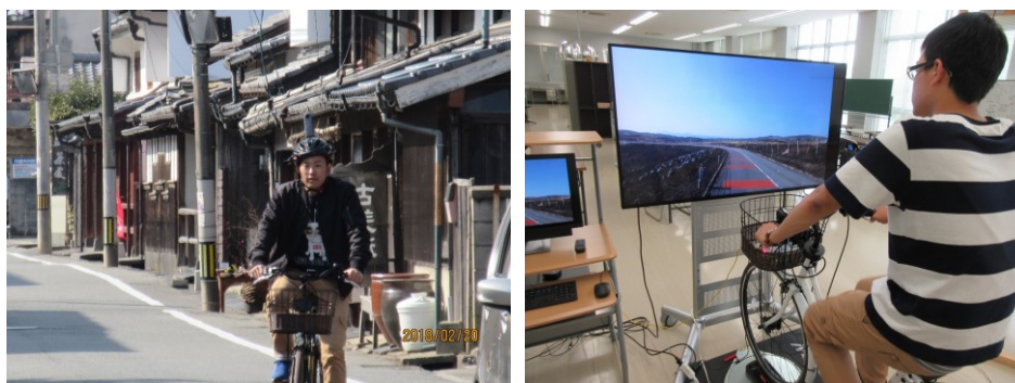
図 4. ヘルメットにカメラをつけて映像を撮影（左）した後、一部映像を切り出し補正し、シミュレータ用映像として利用する（右）。
