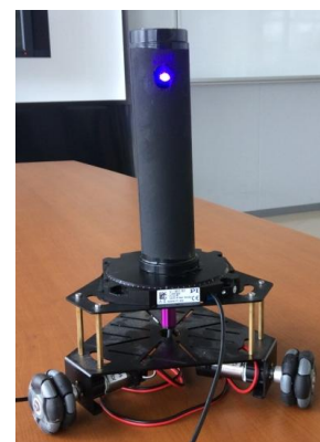
図2 製作したステアリング光学系の全景
