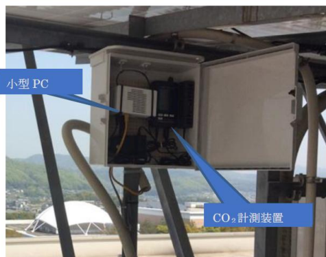
図 3-1-1 CO 2 濃度測定装置設置風景
