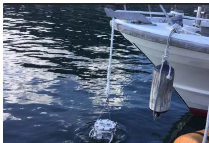
図2 重いカメラは船の舳先からつるして海中に沈める。浅い場所ではバラストをはずして運用することも可能（右）
