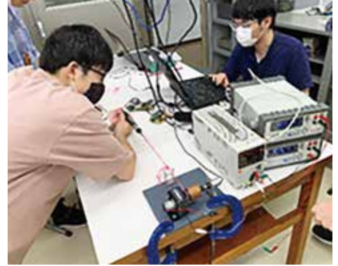
小型 DC モーターの特性計測
