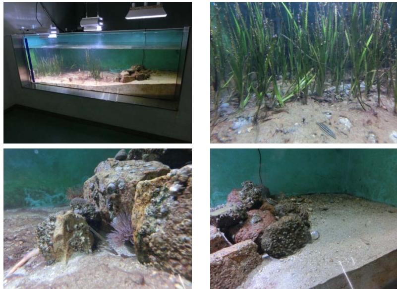
図 5. 水族館 3 トン研究水槽を用いた干満を定期的に繰り返す潮汐水槽.
